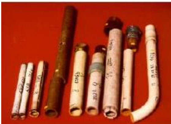
شکل ۱-۱: نمونه لوله‌های پی‌وی‌سی بیرون آورده شده از خاک پس از ۷۰ سال
