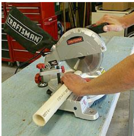
شکل ۵-۸: انواع اره‌های مورد استفاده برای برش لوله‌های یوپی‌وی‌سی
